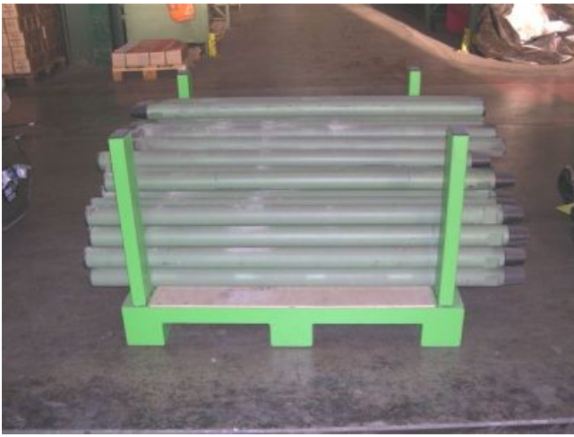
Lagerung von Bohrstangen
