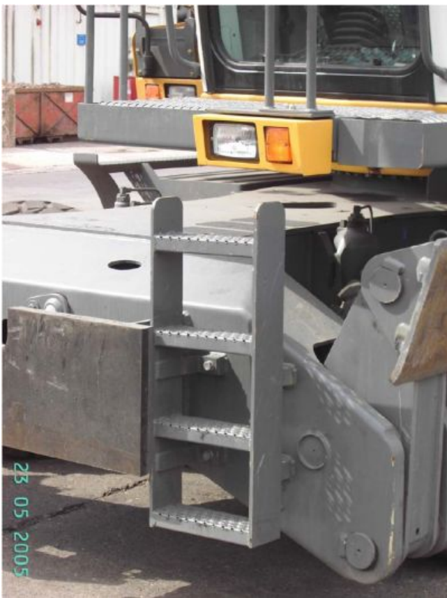
Bagger mit neuem Aufstieg
