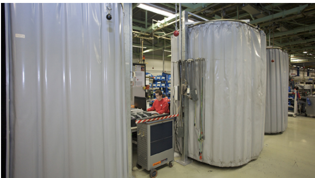
Cisilent kann im Innen- und Außenbereich mobil eingesetzt werden. Foto: bgrci/Plöger.
