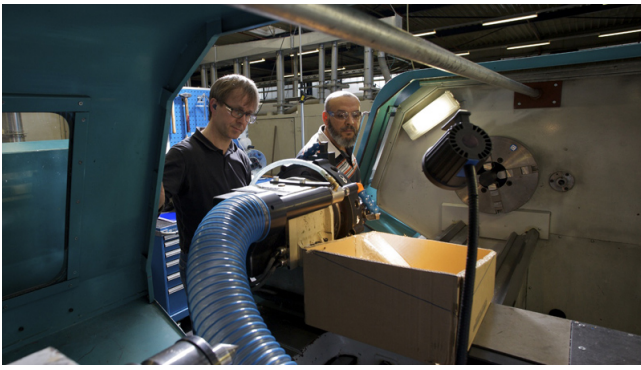
Andreas Wantia (links) und Cabbar Sömnez können dank der Spanabsaugung bei Quadrant nun noch sicherer arbeiten. Foto: bgrci/Plöger
