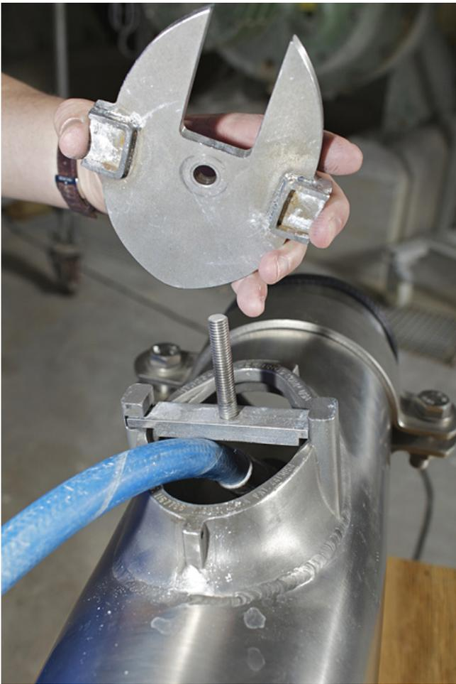
Das Schlauchende mit der Düse bleibt in der Reinigungsöffnung.
