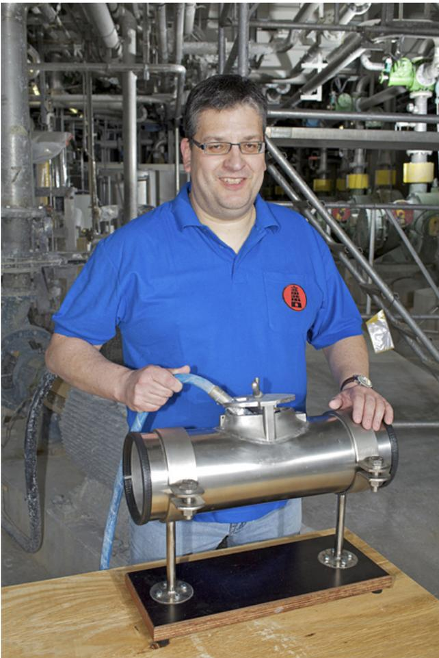
Torsten Hoffmanns Erfindung verhindert, dass Mitarbeiter beim Reinigen von Rohrleitungen von einem Hochdruckwasserstrahl getroffen werden.
