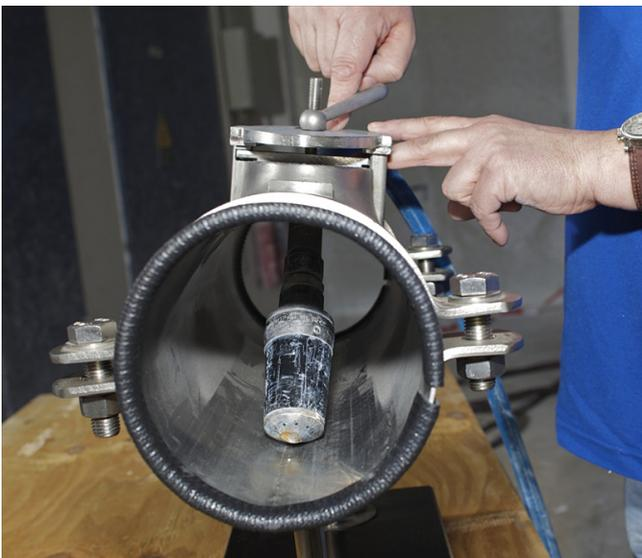
Basis des Systems sind ein standardisierter Deckel und eine Gewindestange mit angeschweißtem Steg.
