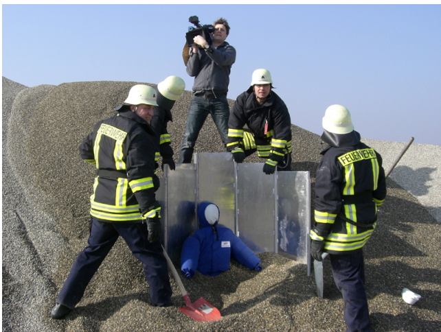
Die Bleche verhindern ein Nachrutschen des Schüttgutes und der Verschüttete kann gerettet werden. Foto: BG RCI
