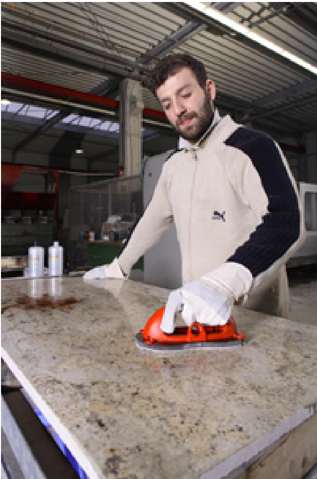
Auftrag des Oberflächenschutzes auf die Natursteinplatte
