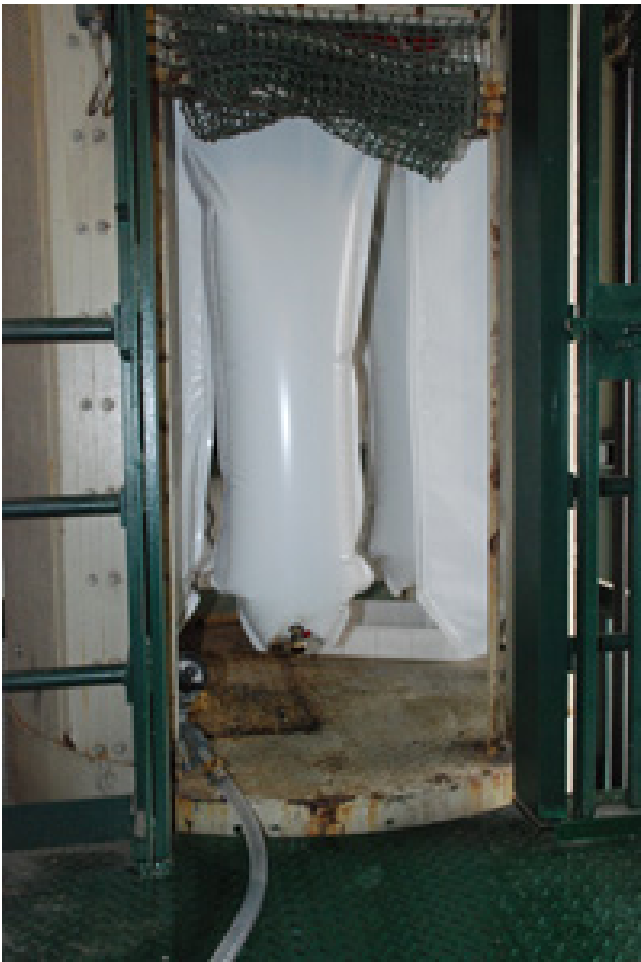
Förderkorb mit Prüfungsgewichten
