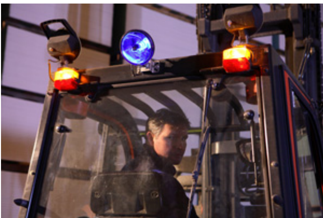
Der Blaulicht-Dachscheinwerfer am Dach des Gabelstaplers
