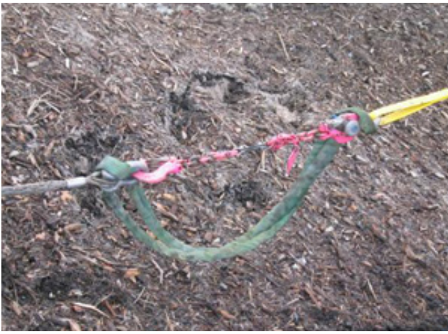
Detail der Bruchsicherung
