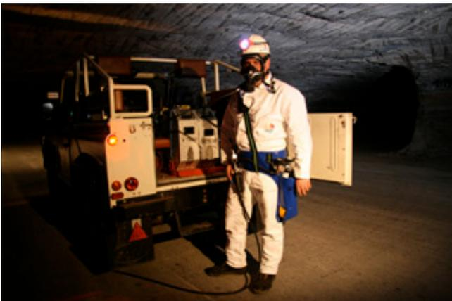
Oft sind unter Tage Kontrollfahrten unter Atemschutzgerät erforderlich, z. B. nach Sprengungen. Die neuen Langzeitatemschutzgeräte werden auf den Fahrzeugen platziert. Sie haben lange Verbindungsschläuche, die beim Fahren nicht behindern.
