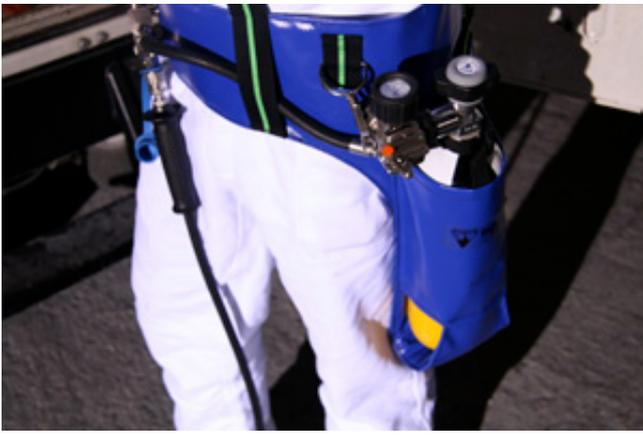
Sollte die Atemluftversorgung über den Verbindungsschlauch ausfallen, springt automatisch die Notluftversorgung an, die eine Reserve von 15 Minuten vorhält.
