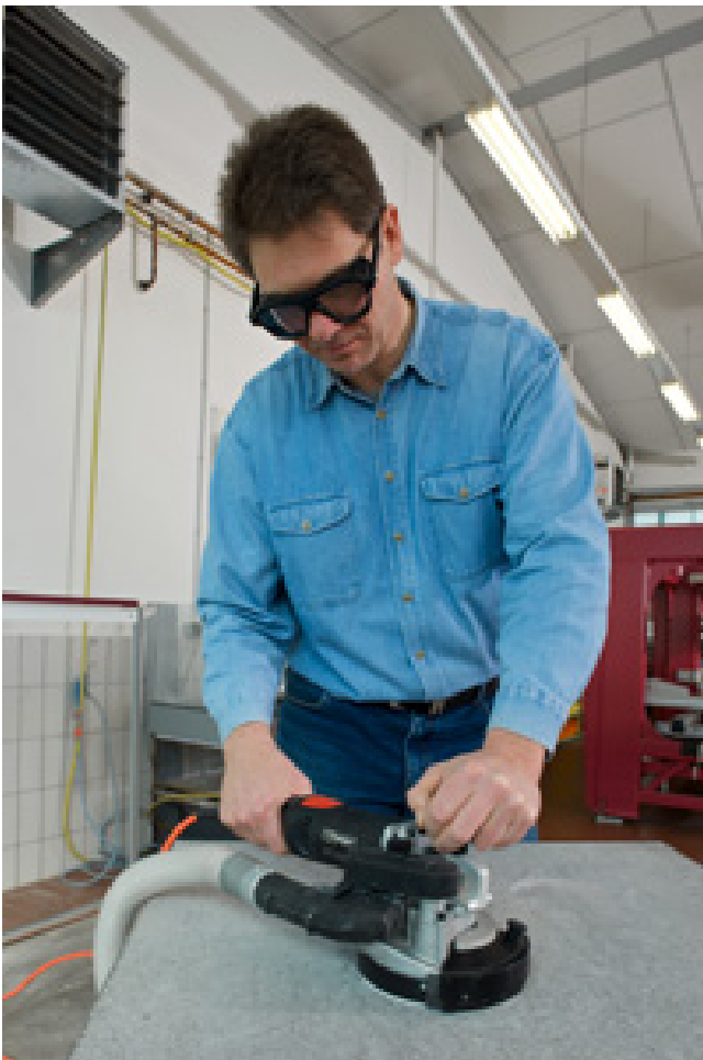
Staubabsaugung beim Schleifen einer Natursteinplatte
