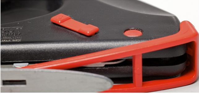
An den Messern gab es eine Schwachstelle: Ein Arretierungsbolzen, der das Klingenlager und damit die Klinge freigibt, wurde immer wieder ungewollt betätigt. Mit dem veränderten Arretierungsbolzen (rechts im Bild) ist nun ein unbeabsichtigtes Auslösen ausgeschlossen.
