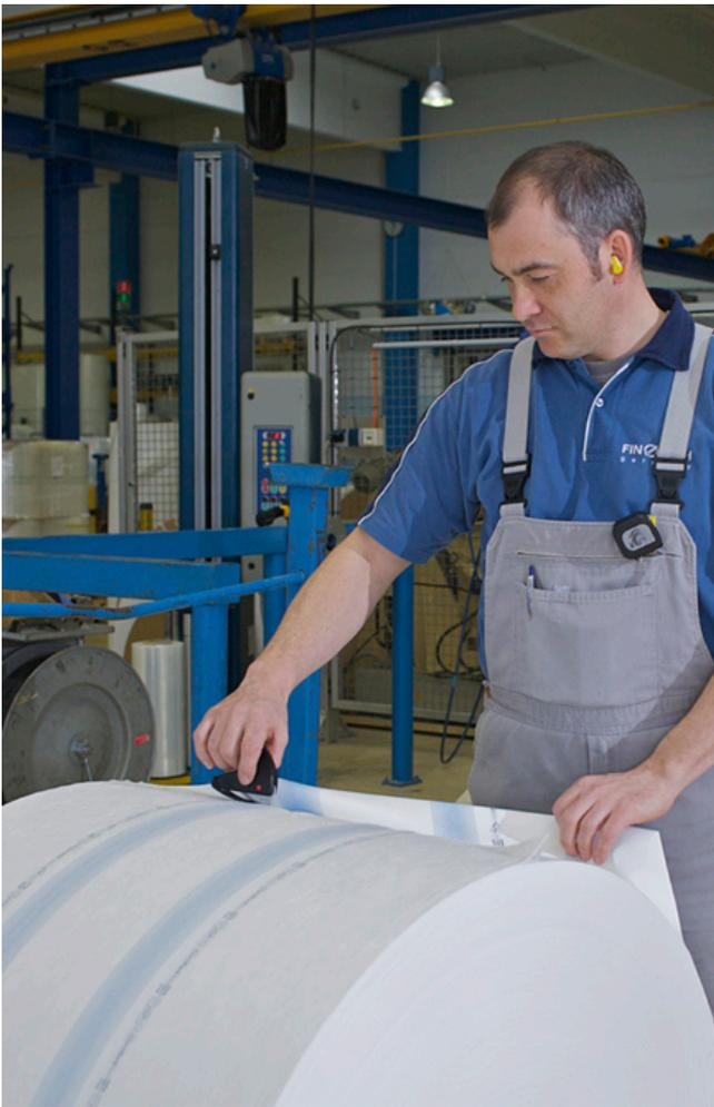
Bei der Folienherstellung ist es üblich, Handmesser zu verwenden, um die Folienbahnen zu schneiden. So auch bei der Firma Clopay Aschersleben GmbH, wo ein Sicherheitsmesser verwendet wird, bei dem die Klinge so verdeckt ist, dass man sie mit den Fingern nicht erreichen und sich nicht verletzen kann.
