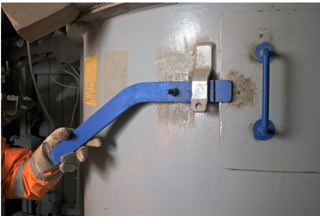
Der Öffnungshebel ist nun nicht mehr an der Klappe selbst, sondern verlängert am Gehäuse der Maschine angebracht.
