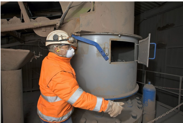
Beim Öffnen selbst steht der Mitarbeiter nun weit genug von der Klappe weg, so dass ihm keine Steine mehr auf die Beine fallen können.
