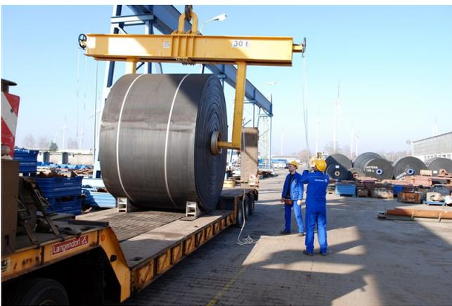
Die Greifarme der neuen Transporttraverse können an die jeweilige Gurtbreite angepasst werden.
