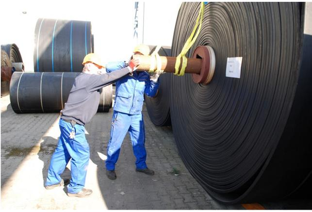
Für den Transport mussten bisher schwere Stahlrohre von Hand eingeschoben werden.
