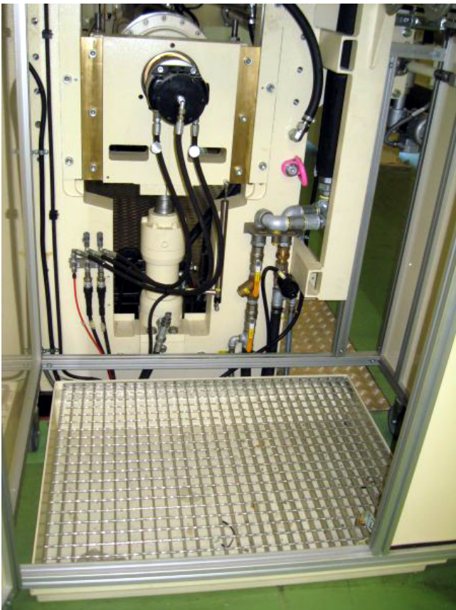
Innenbereich mit Auffangwanne
