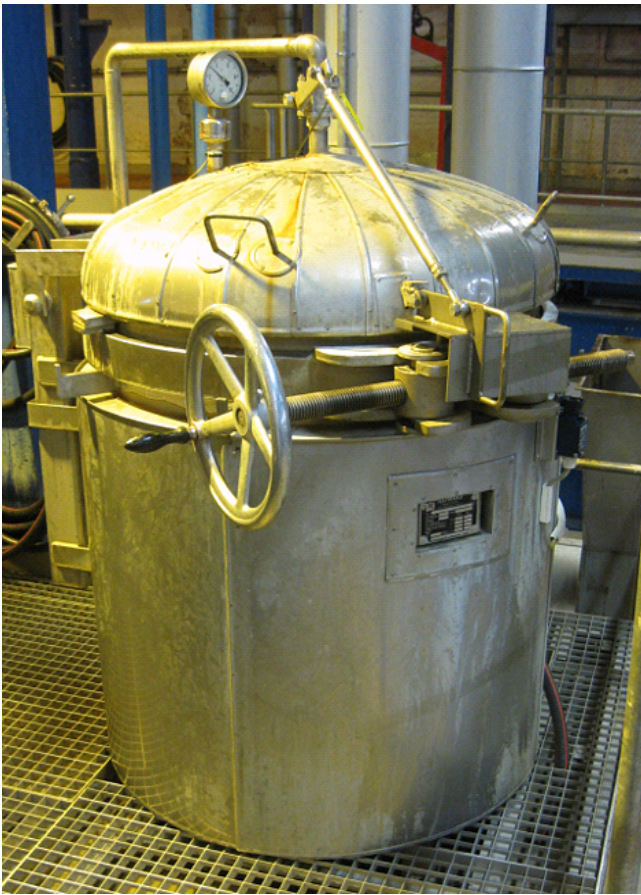
Gesamtansicht eines nachgerüsteten Filters
