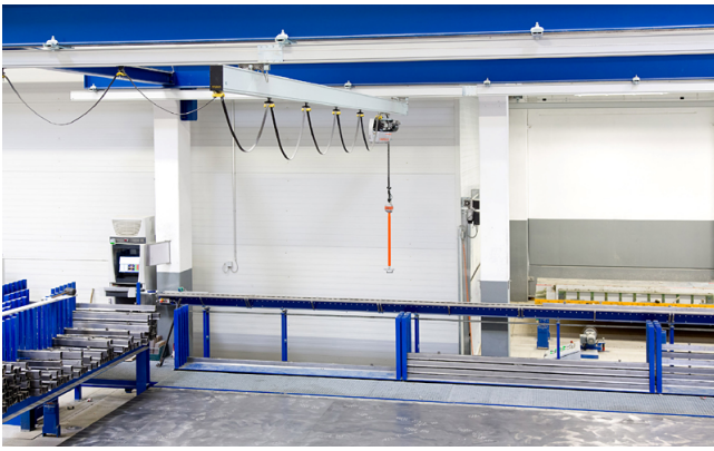
Einschalbereich: Schalungsmanipulator mit Seilhubgerät an x-/y-Schienensystem
