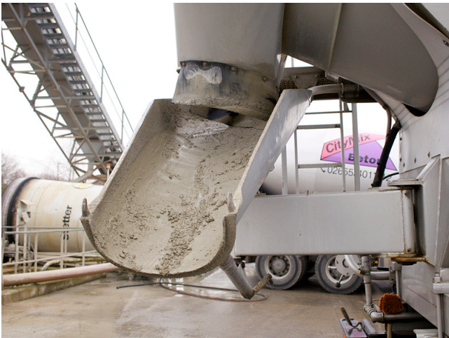
Betonreste können auf die Fahrbahn gelangen und andere Verkehrsteilnehmer gefährden.
