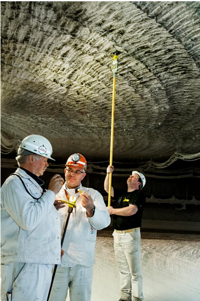
Mit der gleichzeitig neu entwickelten, verlängerbaren Aufschraubvorrichtung wird die wiederverwendbare Anschlagöse von der Sohle aus und von Hand auf die Anker aufgeschraubt.
