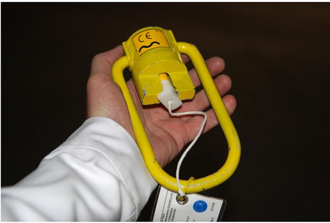
Die neue, wieder verwendbare Anschlagereinrichtung wird auf die Gebirgsanker aufgeschraubt. Die Anschlagöse ist geprüft, als Persönliche Schutzausrüstung gegen Absturz zugelassen und gekennzeichnet.
