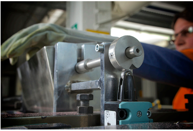
Schutzeinrichtung stoppt gefährbringende Bewegung
