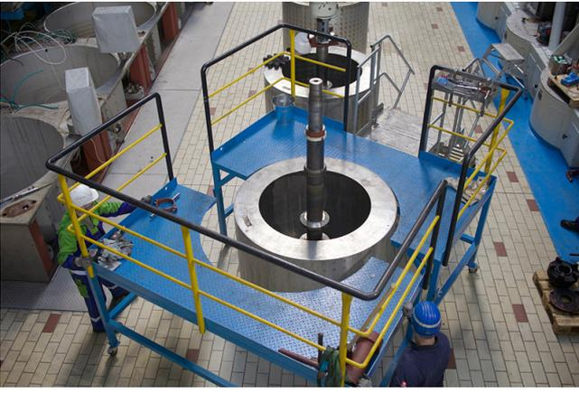
Die Sicht von oben zeigt sehr gut, wie die neue fahrbare Plattform die gesamte Zentrifugentrommel umschließt.
