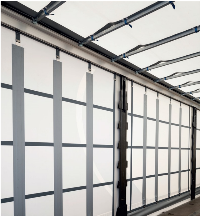
FABRI-MOLL Safe Curtain® als zusätzliche Ladungssicherung.
