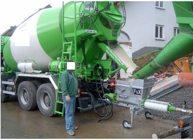
Fahrmischer mit (rechts) und ohne (links) Verlängerungsrutsche
