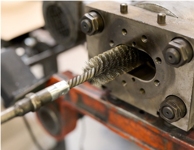
Die Reinigungsbürste am Extrudereingang.
