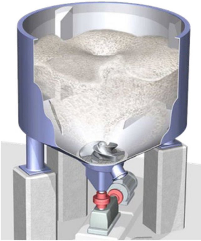
Bütte schematischer Aufbau
